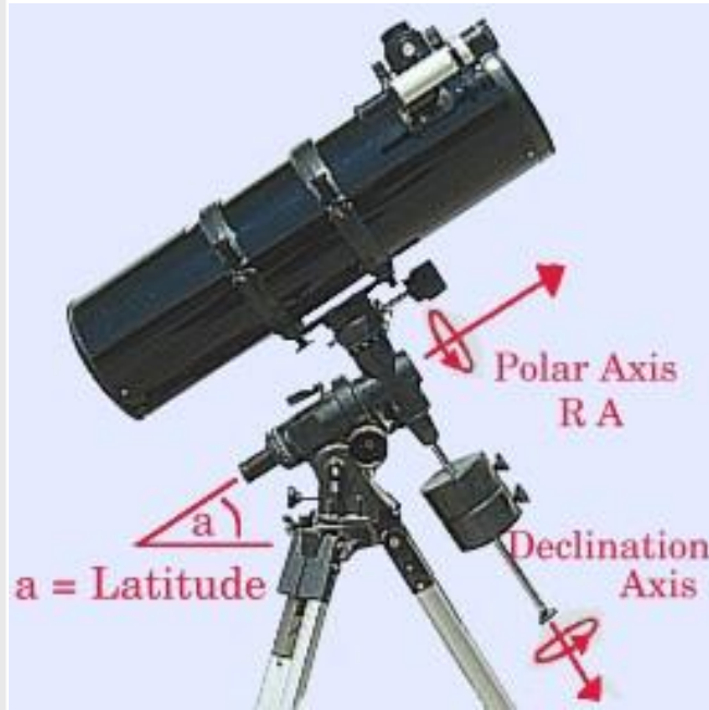
شكل رقم (3). زاوية الارتفاع الشاقولي لحامل التليسكوب الاستوائي وهي نفس قيمة خط العرض للمدينة التي يجري فيها نصب التليسكوب.
